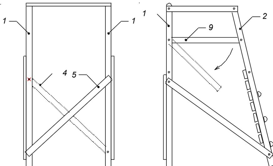
Enlevez le boulon de support demi- rondin de derrière du côté intérieur (pos.4) des pieds ronds de derrière (pos.1);
