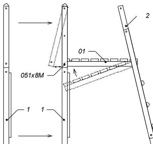
6. Mettez les boulons de fixation M8x100 dans les trous de supports demi- ronds latéraux (pos.7,8), déjà assemblés aux pieds de devant ou aux pieds de derrière (pos.1, 2).
