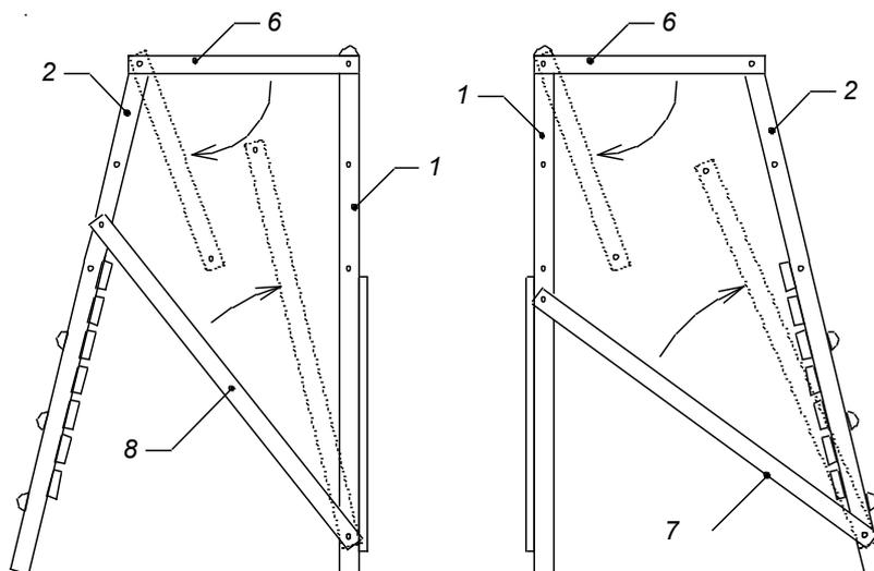
Enlevez les boulons des arrêts-barrage latéraux (2 pièces) (pos.6) d'un des côtés des pieds ronds de devant (pos.2) puis du deuxième côté des pieds ronds de derrière (pos.1)
