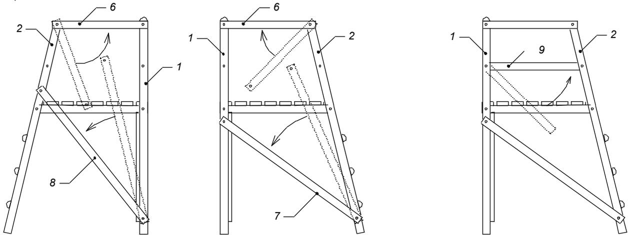
Mettez les boulons de fixation M8x100 dans les trous de supports demi- ronds de siège (2 pièces) (pos.9), déjà assemblés aux pieds de derrière (pos.1).
